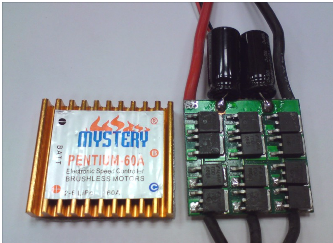
Bild 1: eloxierter Kühlkörper (links) & Draufsicht auf die Platine des P60 A (rechts)
